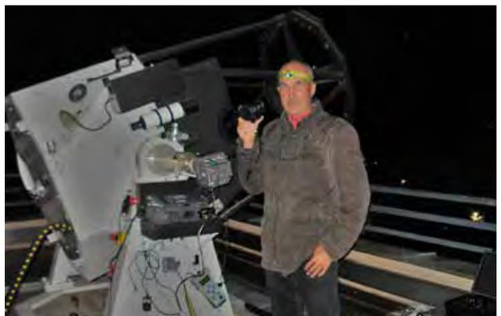
3 Das alt-azimutal montierte 80-cm-Teleskop der Volkssternwarte München ist eines der wenigen Teleskope, dessen Nachführgeschwindigkeit genügend schnell und genügend präzise zur Verfolgung eines ISS-Überflugs ist.
