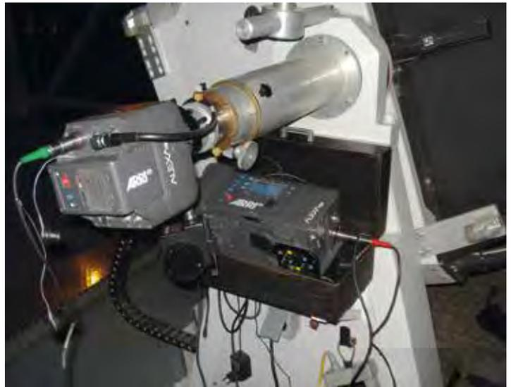
2 Der Kamerakopf der ARRI Alexa M am Nasmyth-Fokus des 80-cm-Cassegrains ( $f/10$ ) der Volkssternwarte München; unten die Kamerabasisinheit. Die Signalübertragung erfolgt durch ein Glasfaserkabel.
