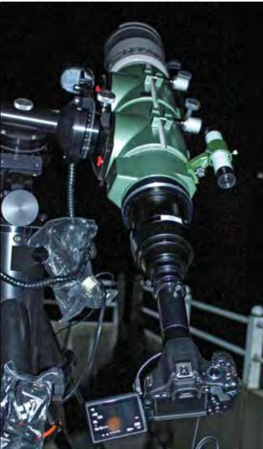
5 Der Pentax-Refraktor auf einer G11-Montierung von Losmandy mit angeschlossener Canon EOS 600D im Video-Crop-Modus, hier: 10 $\times$ . Siehe das Marsbild auf dem Display.
