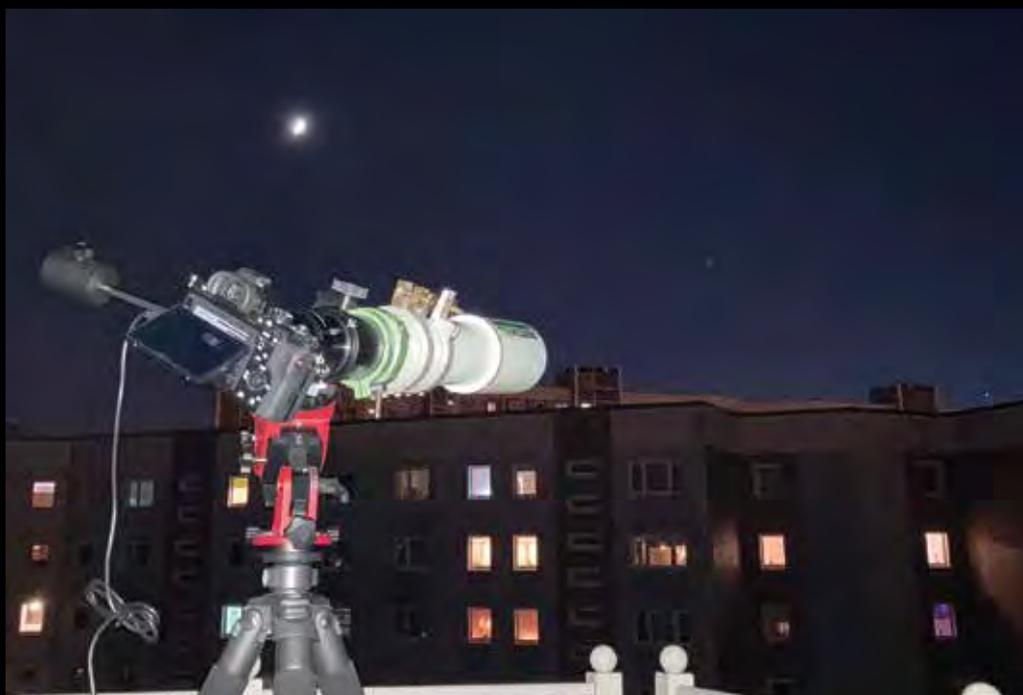
10 Olaf Squarra hatte mehr Glück mit dem Wetter. Über den Dächern von Rostock erwischte er die Konjunktion sowohl am 19. als auch am 21. Dezember. Das Bild zeigt die verwendeten Geräte: Die Montierung Star Adventurer wurde mit einem Pentax-Refraktor 75 EDHF mit TeleVue 4 × Powermate ( $f_{\text{eff}} = \text{ca. } 2.000 \text{ mm}$ ) und Kamera Sony Alpha 7s bestückt – besser gesagt, etwas überladen. Doch trotz einigem Ungleichgewicht konnte noch eine Stunde nachgeführt werden.
